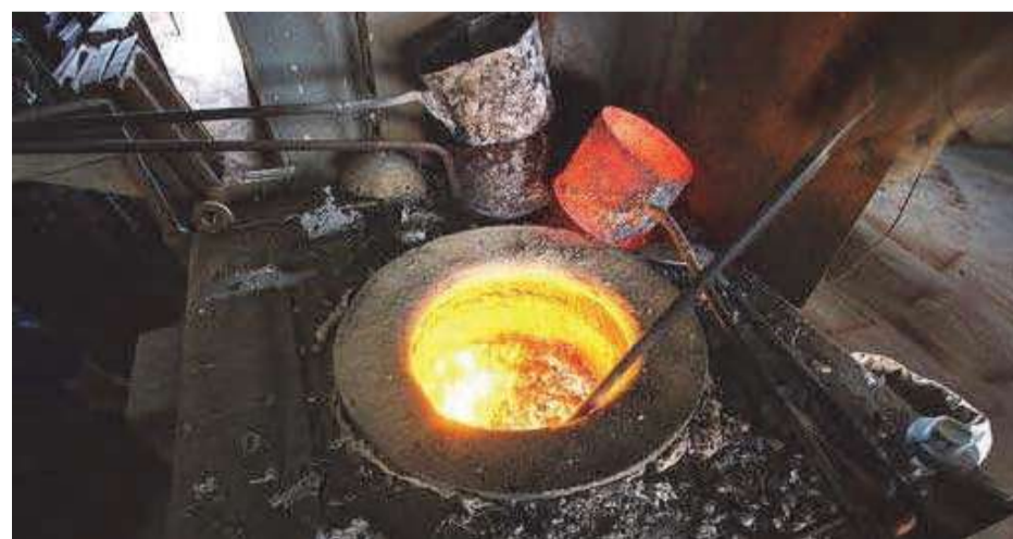
Diglen med det rødglødende smeltede aluminium, der støbes skilte af.
