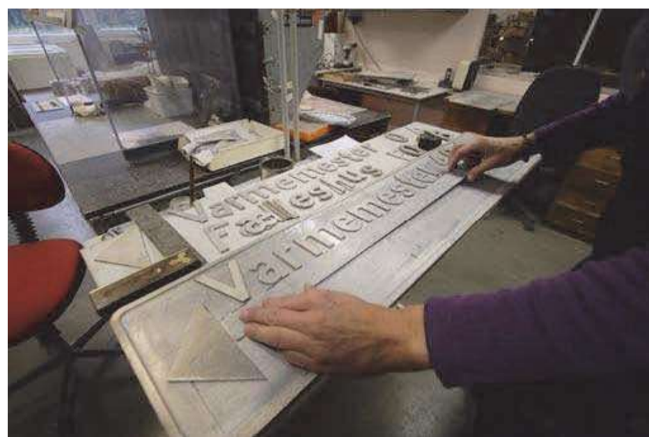
Sætteriet hvor de mange forme til de støbte aluminiumsskilte bliver skabt.
